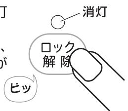
● 給湯後、ロックキーを押さなくても、約10秒過ぎると、安全のためロック解除ランプが消え、自動的にロック状態になります。
